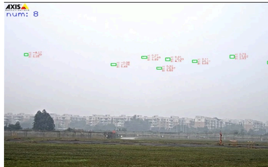
单目摄像头，飞鸟检测，3D定位，<1米定位误差
